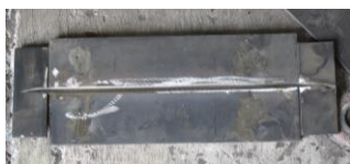
ภาพที่ 8: แผ่นเหล็กชิ้นงานทดสอบขนาด 150x350x9 มิลลิเมตร
