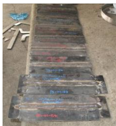
ภาพที่ 9: ชิ้นงานที่เชื่อมเสร็จเรียบร้อยแล้วจำนวน 8 ชิ้นงานทดสอบ
