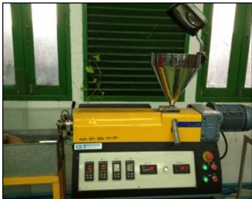
ภาพที่ 1 เครื่องอัดรีดแบบเกลียวนอนเดี่ยว
