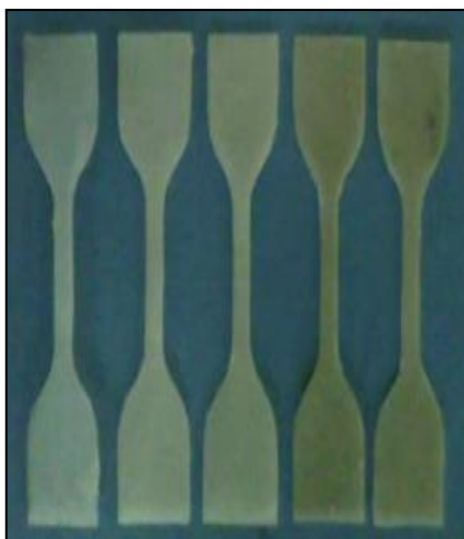
ภาพที่ 5 ชิ้นงานทดสอบแรงดึงตามมาตรฐาน ASTM D 638 Type IV
