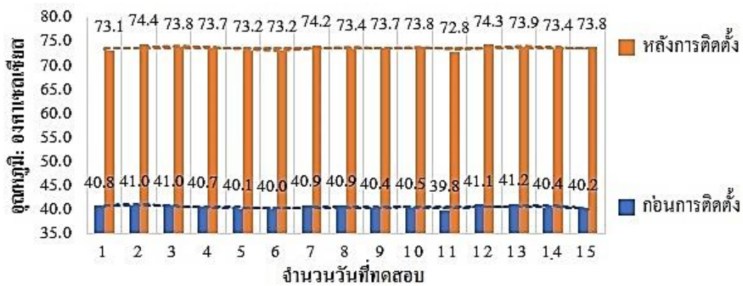
ภาพที่ 15 กราฟแสดงเปรียบเทียบอุณหภูมิน้ำป้อนเข้าเครื่องกำเนิดไอน้ำก่อนและหลังการติดตั้งเครื่องแลกเปลี่ยนความร้อนแบบการไหลปั่นป่วน
