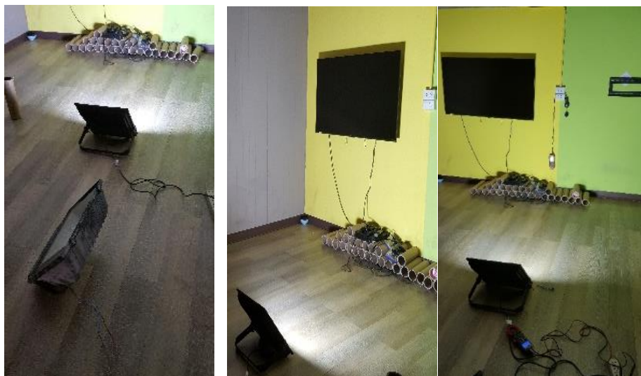
ภาพที่ 7 การทดลองทางแสงของคอมไฟฟลัดไลท์ชนิดหลอดเมทัลฮาไลด์ ขนาด 400 วัตต์และคอมไฟฟลัดไลท์ชนิดหลอดแอลอีดีขนาด 250 วัตต์
