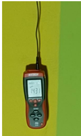
ภาพที่ 9 การทดลองวัดค่าความสว่าง และสังเกตความถูกต้อง และความผิดเพี้ยนของสีด้วยสายตาของโคมไฟหลอดแบบใช้หลอดไฟเมทัลฮาไลด์ และโคมไฟหลอดไลท์ชนิดหลอดแอลอีดี
