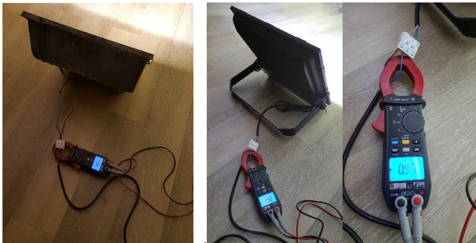
ภาพที่ 8 ผลการทดลองวัดค่าต่างๆ ทางไฟฟ้าของโคมไฟหลอดไฟชนิดหลอดเมทัลฮาไลด์ และโคมไฟหลอดไฟชนิดหลอดแอลอีดี
