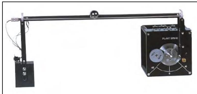
รูปที่ 2 ระบบควบคุมตำแหน่งลูกบอลบนคานของบริษัท Quanser [8]
