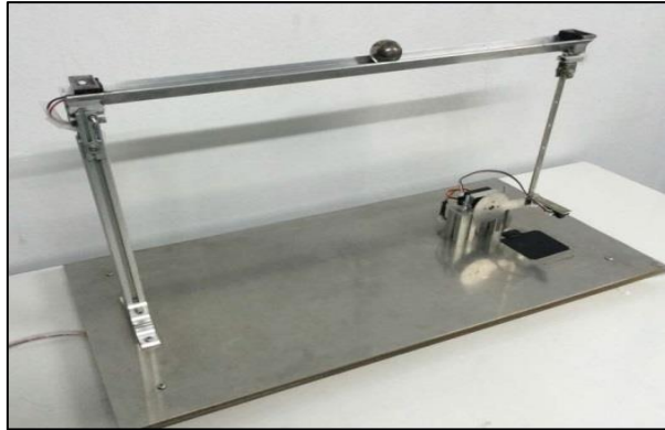
รูปที่ 1 โครงสร้างระบบควบคุมตำแหน่งของลูกบอลบนคาน แบบฟิชชีสไลด์ดิ่ง [7]
