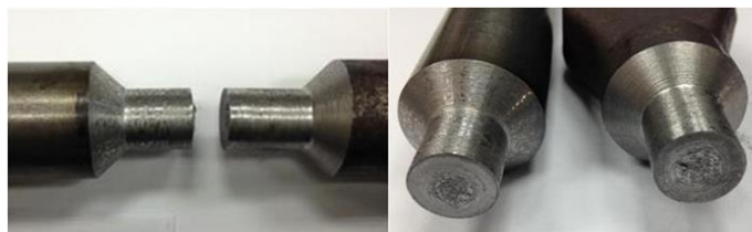
รูปที่ 11 แสดงชิ้นทดสอบเสียหายแบบเปราะที่มีพันธะเชื่อมติดกันบริเวณตรงกลาง
