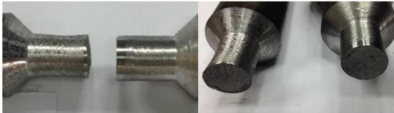
รูปที่ 13 ชิ้นทดสอบเสียหายแบบเปราะที่มีพันธะเชื่อมติดกันทั้งหมด
