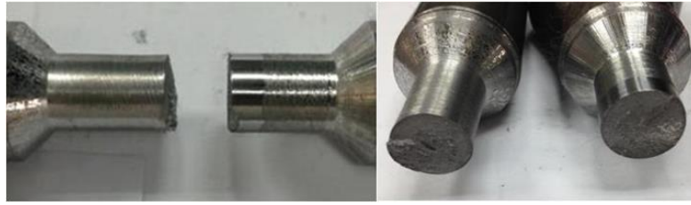
รูปที่ 12 ชิ้นทดสอบเสียหายแบบเปราะที่มีพันธะเชื่อมติดกันส่วนใหญ่
