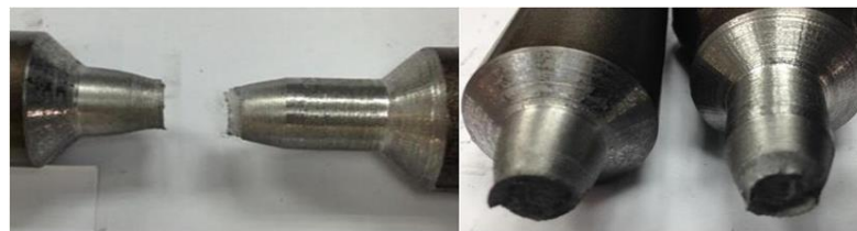
รูปที่ 14 ชิ้นทดสอบเสียหายแบบเหนียวมีพันธะเชื่อมติดกันทั้งหมด
