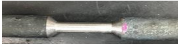
รูปที่ 6 ตัวอย่างชิ้นงานทดสอบแรงดึง
