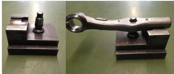
รูปที่ 5 Jig จับยึดชิ้นงานในการเชื่อมแบบแรงเสียดทาน
