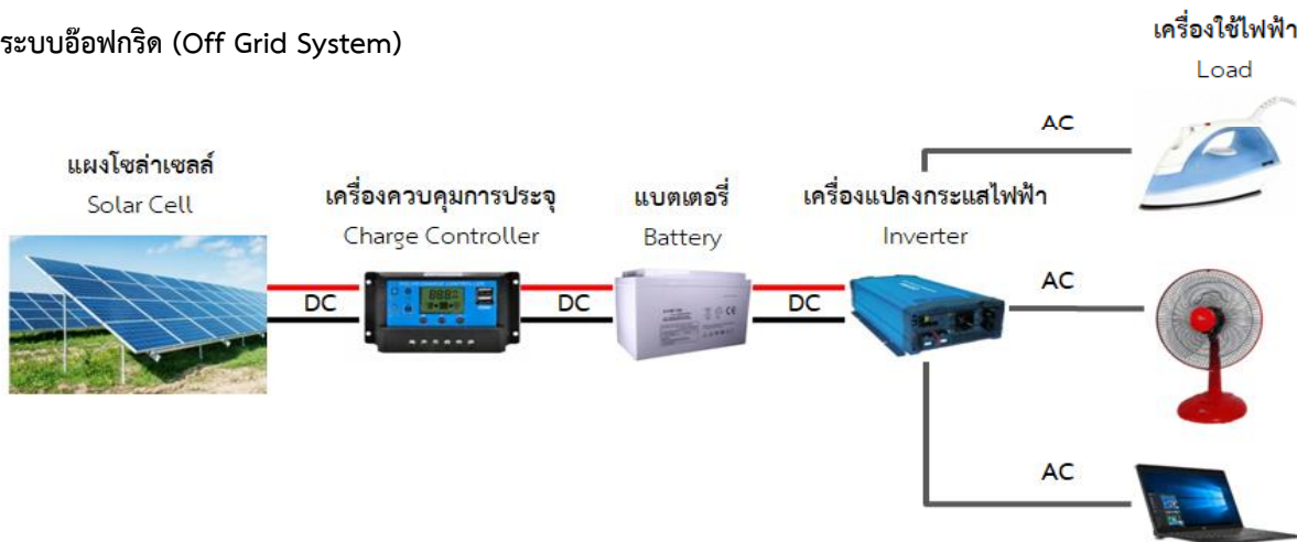
รูปที่ 1 โซลาร์เซลล์ระบบออฟกริด (Off Grid System) (ปณต ศรีภกรชต์, 2561)
