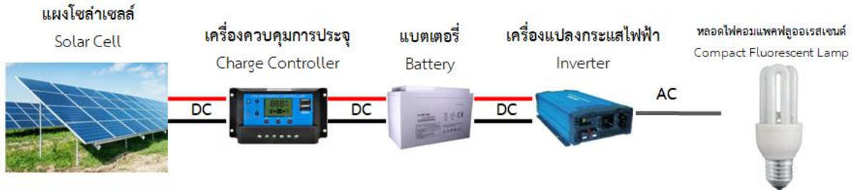
รูปที่ 2 แบบโครงสร้างของระบบแสงสว่างด้วยพลังงานไฟฟ้าจากเซลล์แสงอาทิตย์ ณ ลานปฏิบัติธรรมวัดป่าธรรมศิริ (ปนต์ ศรีภักดิ์, 2561)
