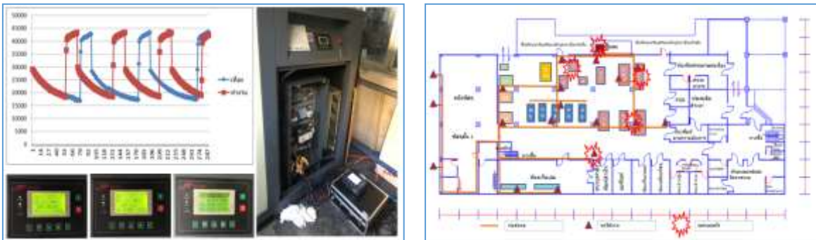
รูปที่ 7 การตรวจวัดประสิทธิภาพของเครื่องอัดอากาศและจุดรั่วไหลของอากาศอัด (ชัชวาล สมานสุข, 2562)
