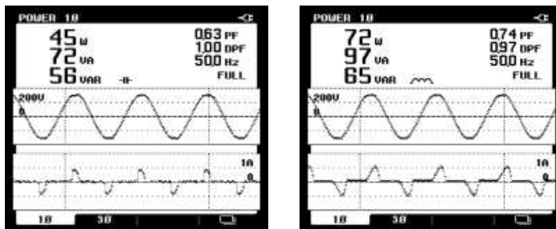
รูปที่ 5 ค่ากำลังไฟฟ้าที่บริโภคของ CPU unit only และของจอภาพ CRT only
