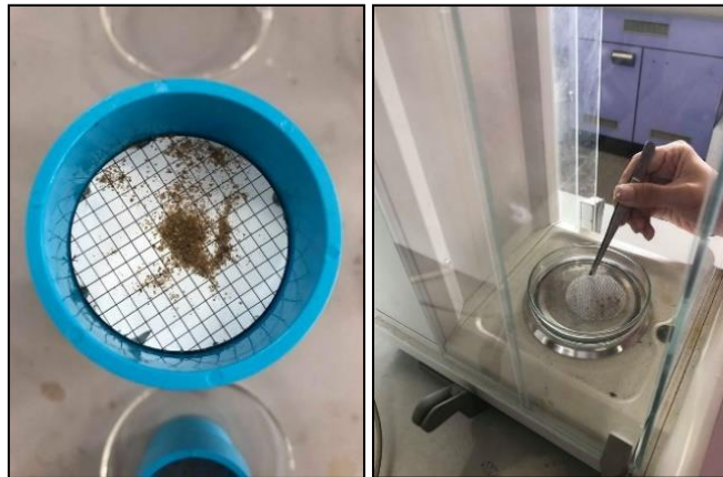
ดั่งรูปที่ 9 นำแผ่นกรองมาชั่งน้ำหนัก (โกสินทร์ชัย แผ้วไธสง, 2562)
