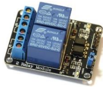
รูปที่ 4 Relay Module ที่ใช้ควบคุมอุปกรณ์ไฟฟ้า (จิรวินัญ ดีเจริญชิตพงค์, 2562)
