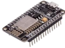
รูปที่ 3 อุปกรณ์ไมโครคอนโทรลเลอร์ NodeMCU ESP8266 (จิรวินัญ ดีเจริญชิตพงค์, 2562)
