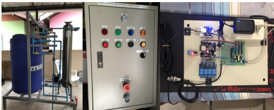
รูปที่ 10 ภาพระบบการเฝ้าติดตามและการบำรุงรักษาเครื่องกรองน้ำที่ได้ออกแบบ (จิรศักดิ์ ส่งบุญแก้ว, 2562)
