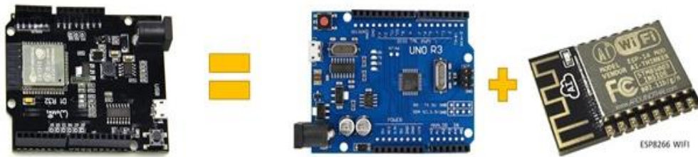
รูปที่ 5 ไมโครคอนโทรลเลอร์ รุ่น WEMOS-D1-R32
