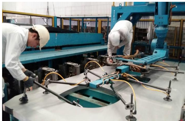
รูปที่ 19 การลือตำแหน่งอุปกรณ์ดูดจับชิ้นงานของแขนหุ่นยนต์ (Robot)
