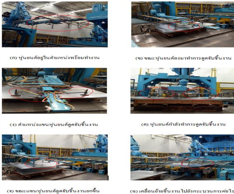
รูปที่ 13 แสดงการทำงานของอุปกรณ์แขนหุ่นยนต์ (Robot) ในกระบวนการผลิตชิ้นส่วนยานยนต์.
