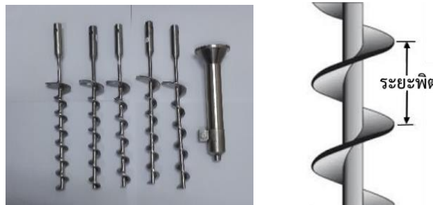
ภาพที่ 2 เกลียวบรรจุระยะพิทที่ 27, 30, 33, 36, 39 มิลลิเมตร (ซ้ายไปขวา) (สุเมธ สิงห์ผู้, 2562)
