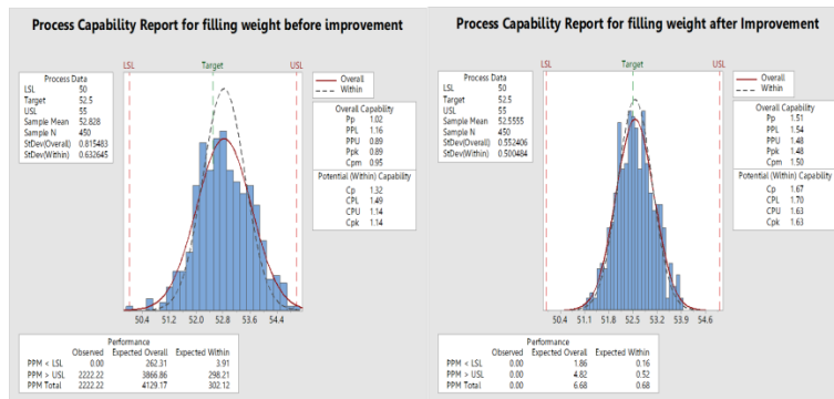
ภาพที่ 9 ผลการวิเคราะห์ความสามารถกระบวนการก่อนและหลังการปรับปรุง
