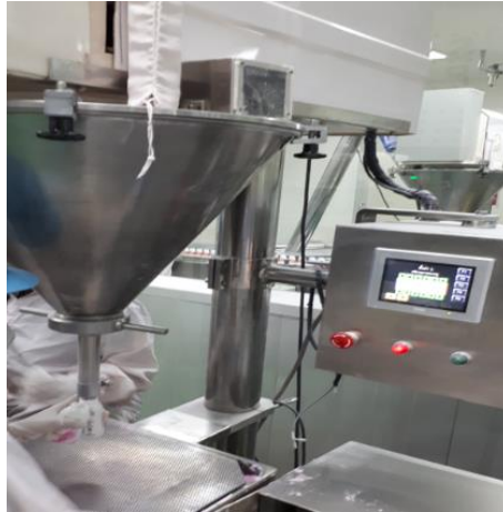
ภาพที่ 5 การบรรจุแป้งด้วยเครื่องบรรจุแบบเกลียว (สุเมธ สิงห์ผู, 2562)
