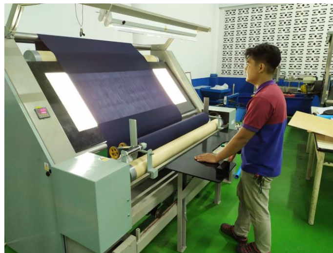
ภาพที่ 11 เครื่องม้วนผ้ากึ่งอัตโนมัติสมบูรณ์
