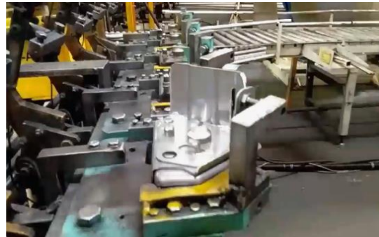
ภาพที่ 3 การนำชิ้นงาน A B และ C ใส่อุปกรณ์จับยึดชิ้นงาน
