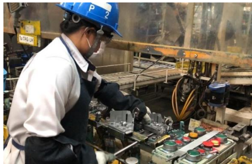
ภาพที่ 4 การงดชิ้นงานเพื่อหยิบชิ้นงานออกจากอุปกรณ์จับยึดชิ้นงาน
