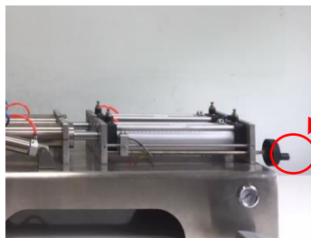
ภาพที่ 15 ตัวปรับระยะของกระบอกสูบกลม (ปวรุตม์ และคณะ, 2563)
