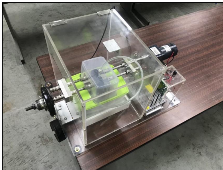
ภาพที่ 4 เครื่องทดสอบการสึกหรอด้านแบบสำหรับการทดลอง
