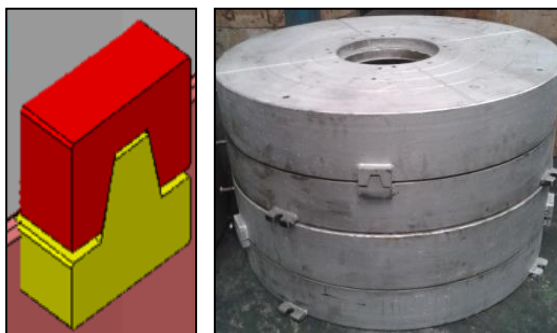
ภาพที่ 13 ลักษณะการใช้อุปกรณ์ล็อก (Lock Plate)
