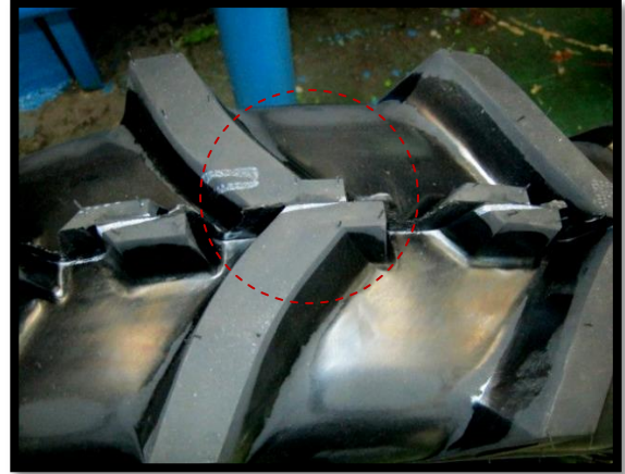
ภาพที่ 5 ลักษณะยางเสียที่เกิดจากพิมพ์เหลื่อม
