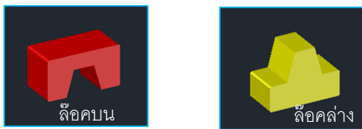
ภาพที่ 12 อุปกรณ์ล็อกแม่พิมพ์ (Lock Plate) ขึ้นส่วนฝาบน และขึ้นส่วนฝาล่าง
