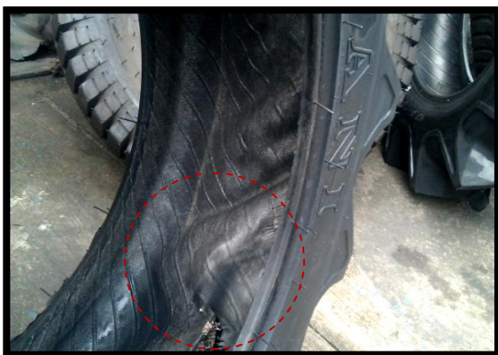
ภาพที่ 4 ลักษณะยางเสียที่เกิดจากแบลดเดอร์หลุด
