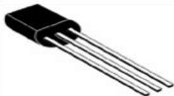
ภาพที่ 5 รูปร่างของไอซีตรวจจับอุณหภูมิ DS1820
