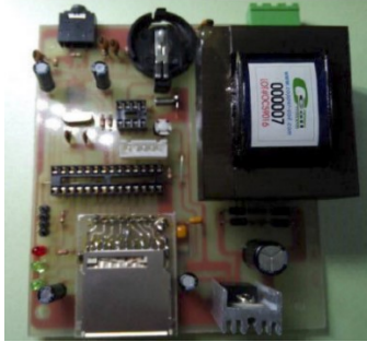
ภาพที่ 1 วงจรภายในเครื่องวัดการใช้พลังงานไฟฟ้า
