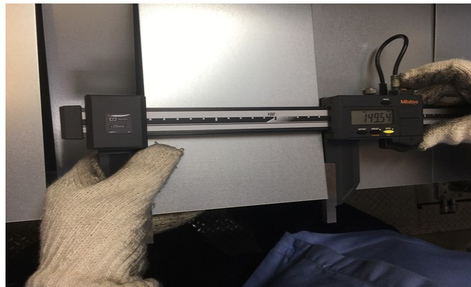
ภาพที่ 23 แสดงวิธีการส่งสัญญาณจาก U - Wave
