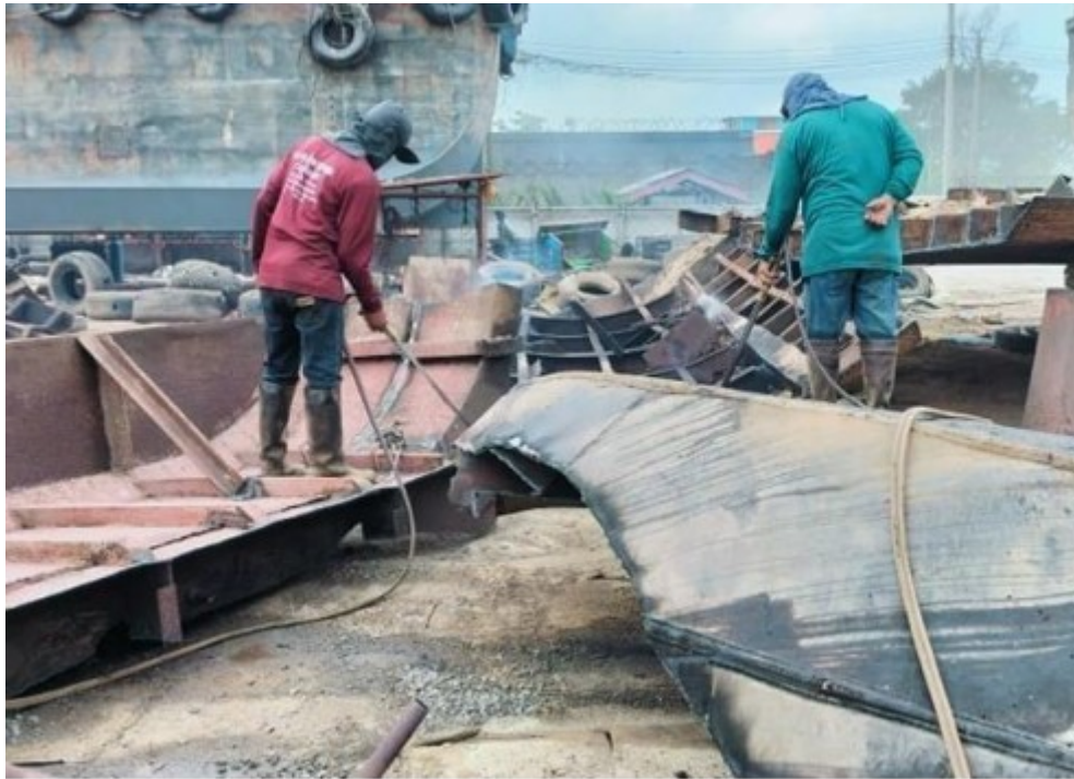
ภาพที่ 1 กระบวนการเชื่อมแผ่นใต้ท่อนเรือ
