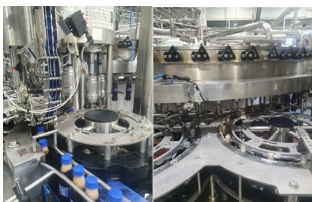
ภาพที่ 7 การบรรจุผลิตภัณฑ์ พร้อมปิดฝา ขั้นตอนที่ 6 การปรับอุณหภูมิผลิตภัณฑ์ ก่อนเข้าแพ็คหีบห่อ ดังภาพที่ 8
