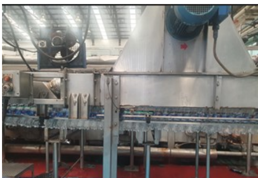
ภาพที่ 5 ลำเลียงขวดพลาสติกด้วยความเร็ว ขั้นตอนที่ 4 การล้างทำความสะอาดขวดก่อนการบรรจุ ดังภาพที่ 6
