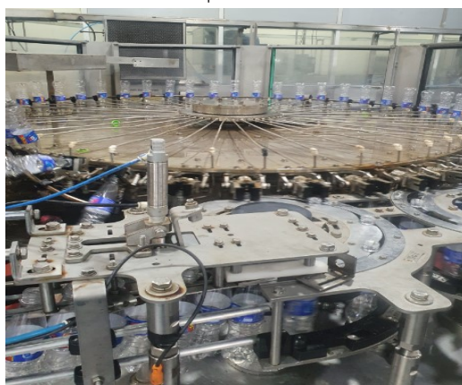
ภาพที่ 6 ล้างทำความสะอาดขวดก่อนการบรรจุ ขั้นตอนที่ 5 การบรรจุผลิตภัณฑ์พร้อมปิดฝา ดังภาพที่ 7
