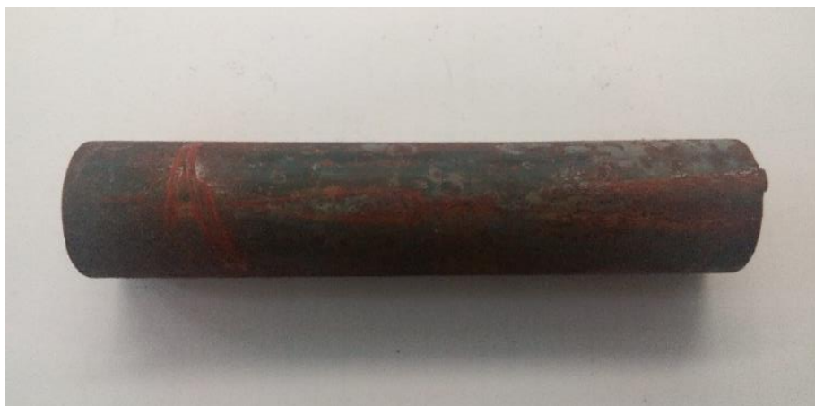
ภาพที่ 1 ลักษณะชิ้นงานในการทดลอง (เหล็กกล้าผสมเกรด AISI 4140)
